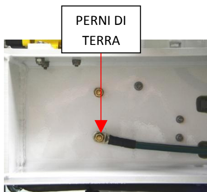
FIGURA 7 – PERNI DI TERRA BASAMENTO POSTERIORE DEL GIROSCOPIO
