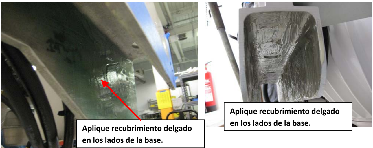
FIGURA 11 – APLICACIÓN DEL ADHESIVO A LOS ASIENTOS
