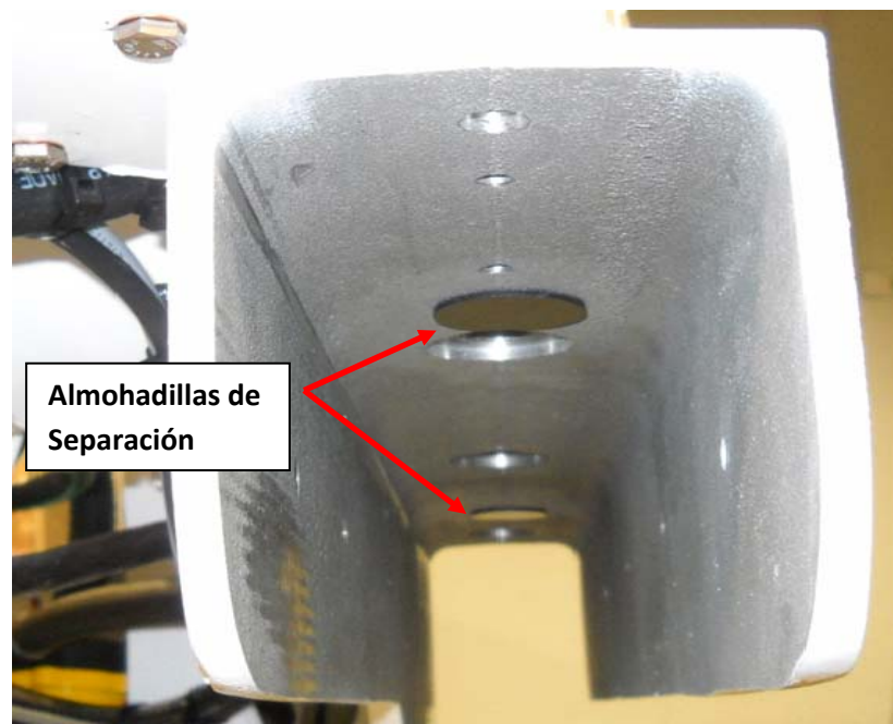
FIGURA 10 – ALMOHADILLAS DE SEPARACIÓN DE NAILON PARA TORNILLOS
