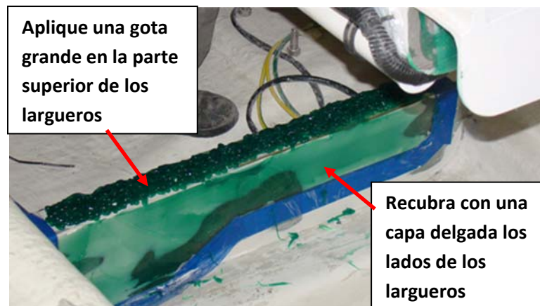
FIGURA 12 – APLICACIÓN DEL ADHESIVO A LOS LARGUEROS
