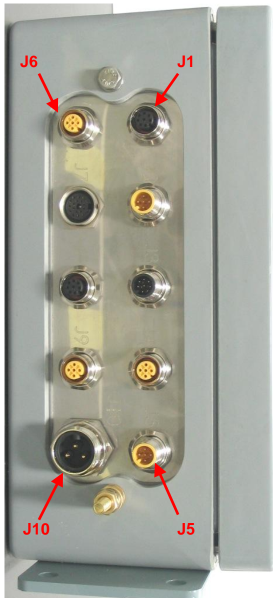
FIGURA 13 – CONECTOARELE CUTIEI DE CONTROL A GIROSCOPULUI
