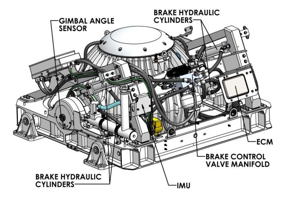
FIGURE 6 - BRAKE SYSTEM COMPONENTS
