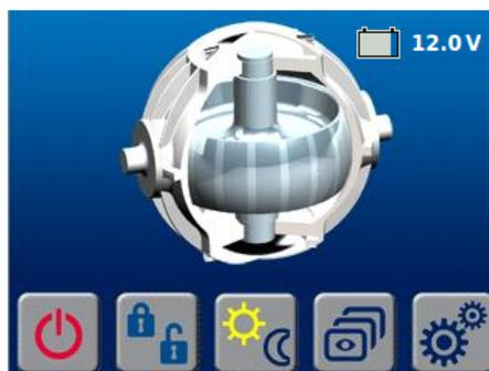
Para ENCENDER el GIRÓSCOPO, pulse el botón ENCENDER/APAGAR RESTABLECER FALLA, el botón se pondrá VERDE, el volante de inercia girará (o aparecerá una flecha) y aparecerá una
