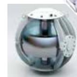
真空の球体の中で、フライホイールが高速回転する。ボートが横方向に揺れると、ジャイロが前後に傾いてトルクが発生し、揺れを抑える
