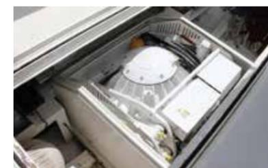
こちらはパートラム54にSeakeeper9を設置した例。アフロテック社が設置を行ったパートラム50で、実際にシーキーパーの実力を
