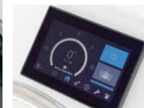
操作パネル。この画面ではボートの傾きを表示しているが、基本的に15度くらいまでの傾きに対してジャイロが利く
