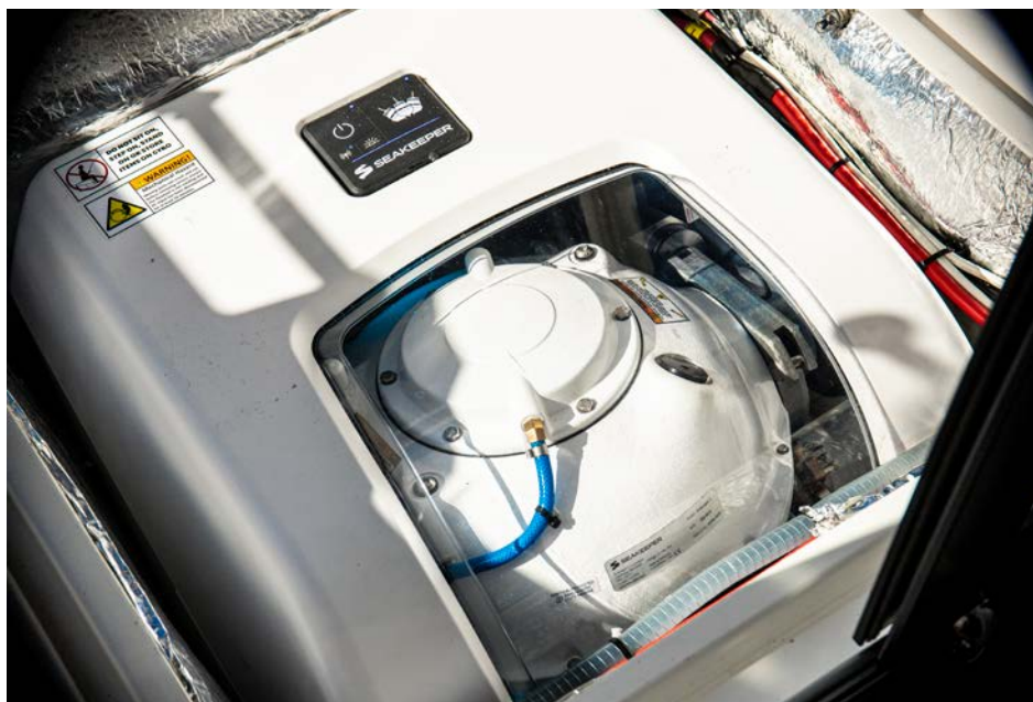
STABILISATOREN er montert i et stuverom under akterdekket og måler 58 x 60 x 40 cm, og rommet er isolert med støydempende materialer.
