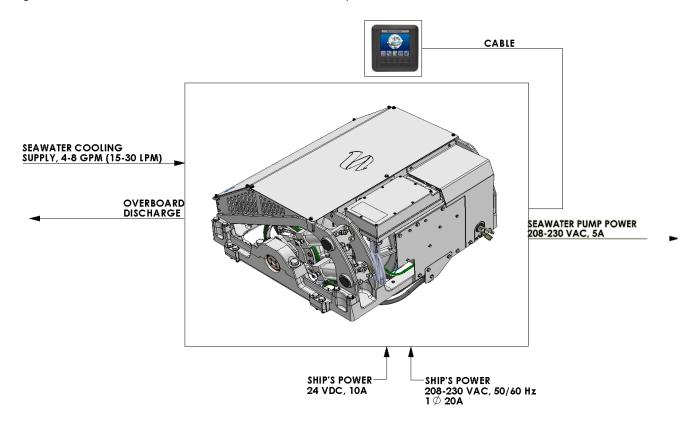
FIGURE 1 - SEAKEEPER 9 STABILIZATION SYSTEM COMPONENTS
