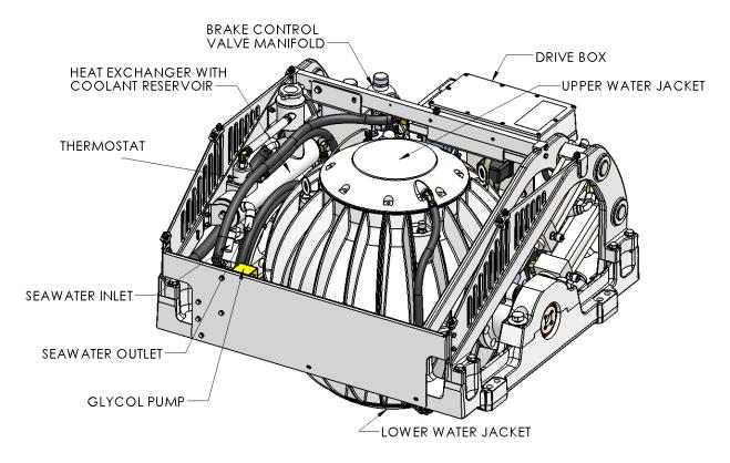
FIGURE 7 - COOLING SYSTEM COMPONENTS
